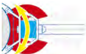
Système anti-rafale avec silentblocs
